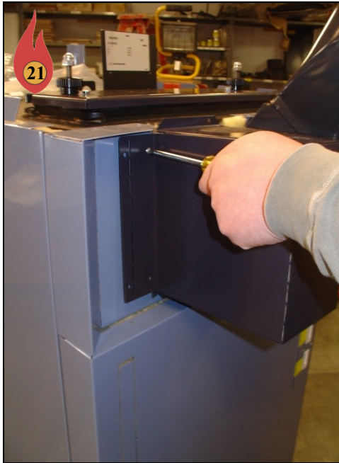
Install Fan Insulation Box
